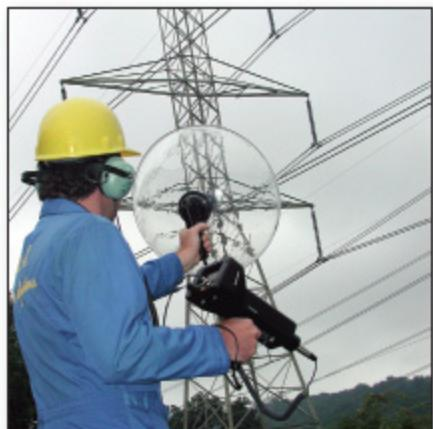
diagnostice. Při vysokých napětcích nad 1000 V vzniká koróna, která způsobuje postupnou degradaci materiálů zařízení, což vede ke ztrátě jejich izolačních a mechanických vlastností. Dále se vyskytuje částečné výboje, plazivé proudy a opět obloukové výboje. Také uvolněné části, které vibrují v rytmu síťové frekvence, generují ultrazvuk, a tak může být detekován i mechanický stav elektrických zařízení.
